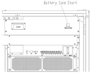
(d) Battery cold start button for 8-slot cabinet UPS
